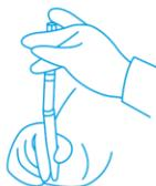
Fixez un filtre à la seringue, poussez lentement l'échantillon d'eau à travers le filtre dans le tube de mélange. Ajoutez la solution liquide Codeac dans le tube mélangeur. Fixez le couvercle et mélangez soigneusement.
